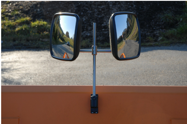
Bild 1: V- oder Seitenblickspiegel für Frontgeräte seit 1. Juli 08 obligatorisch
